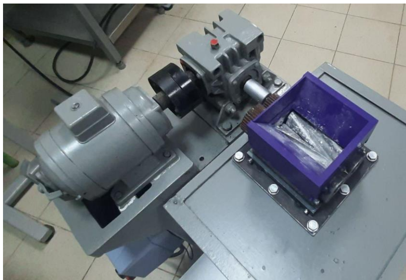
Рис. 4. Лабораторная установка измельчителя
