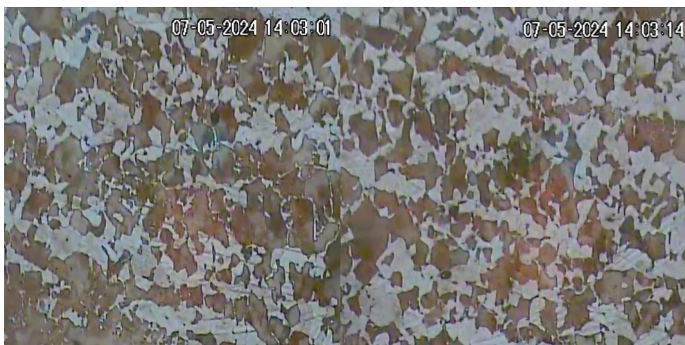
Рис. 2. Структура стали после отжига
