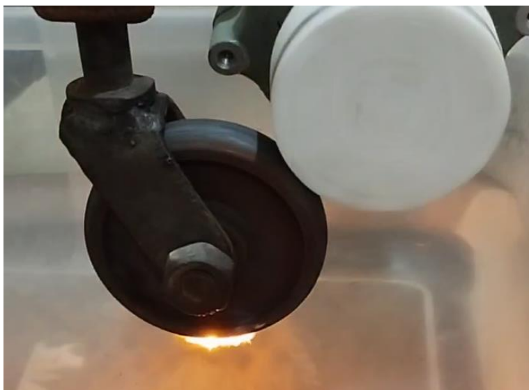
Рис. 1. Закаливаемый образец, колесо и привод
