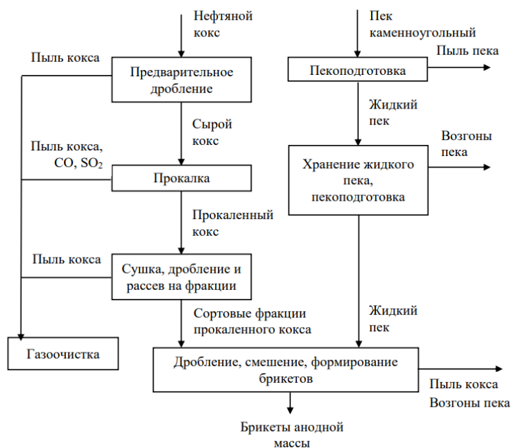
Рис. 1. Упрощенная технологическая схема производства анодной массы
