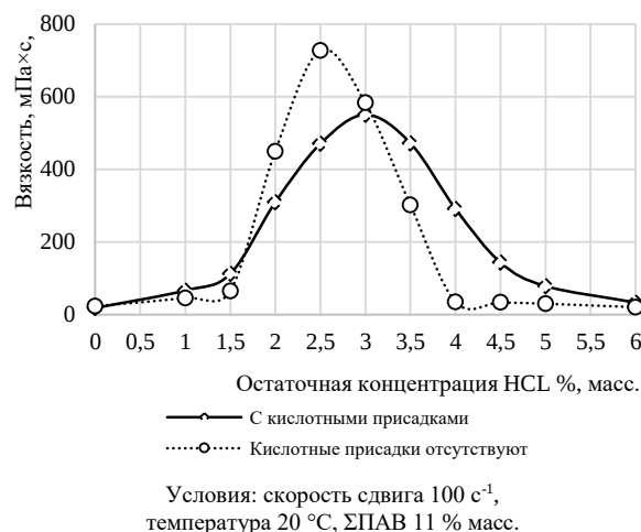
Рис. 2. Зависимость динамической вязкости от остаточной концентрации HCl
