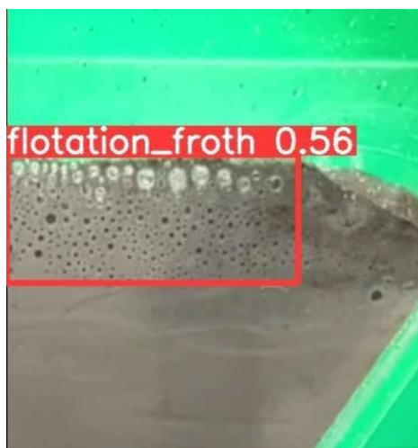
Рис. 1. Процесс обнаружения пенного слоя в кадре записи эксперимента
