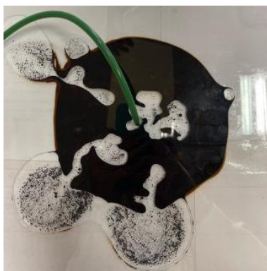
Рис. 3. Вытеснение тяжелой нефти дистиллированной водой в ячейке Хеле-Шоу
