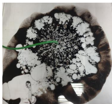
Рис. 5. Вытеснение тяжелой нефти 3 % ПАВом с добавлением 1 % наночастиц
