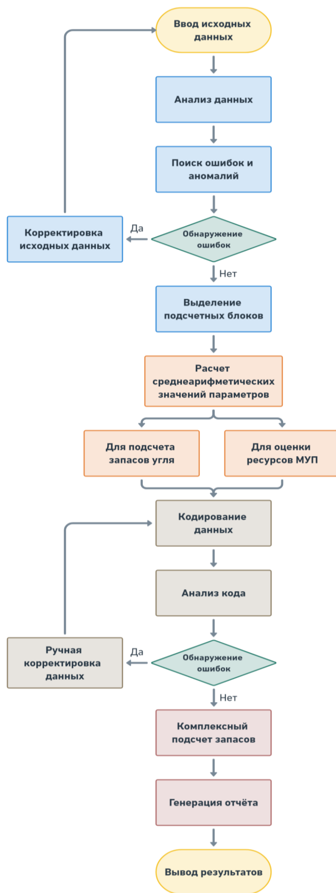
Рис. 1. Принцип работы алгоритмического кода для комплексного подсчета запасов полезных ископаемых кодирования
