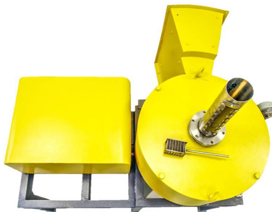
Рис. 2. Вертикальный пульсационный высокоградиентный магнитный сепаратор Slon-100
