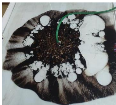
Рис. 4. Вытеснение тяжелой нефти 3 % ПАВом
