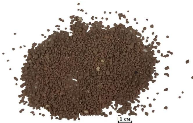
Рис.1 Внешний вид экспериментальной партии пропанта
