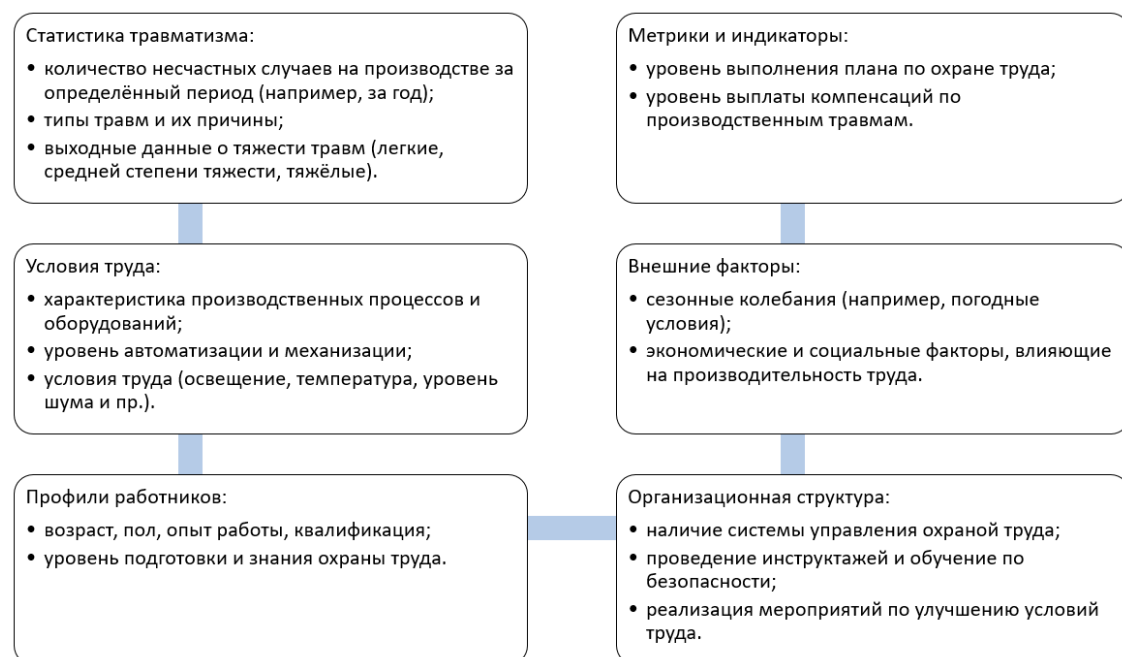
Рис. 3. Входные данные концепции системы раннего предупреждения травматизма на производстве
