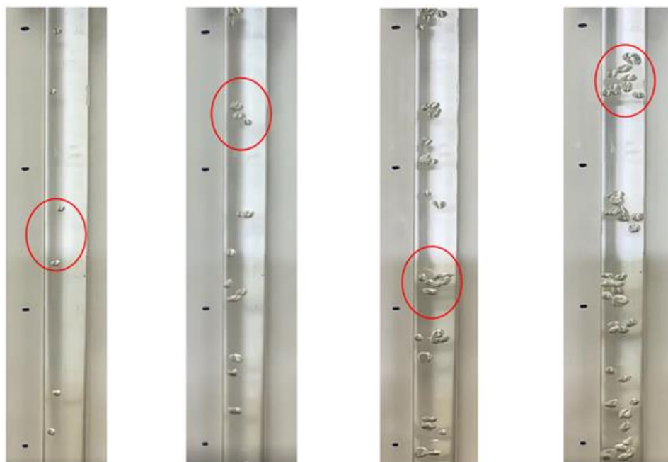
Рис. 4. Движение пузырьков кластерами (от минимальной подачи газа до максимальной – слева на право)
