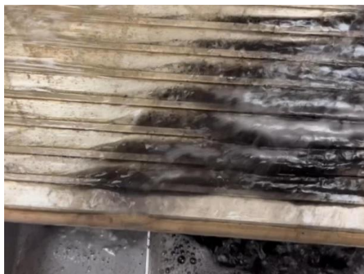
Рис. 2. Процесс флотогравитации на концентрационном столе
