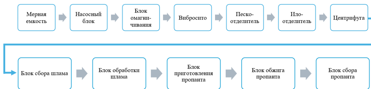
Рис.2 Схема универсального, мобильного комплекса для рециклинга бурового шлама
